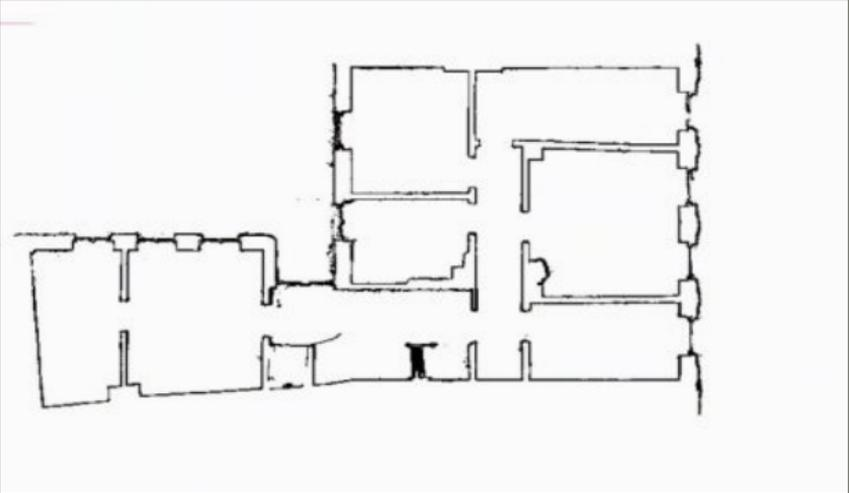
**06** Der Schnitt durch die Punktwolke in einem Meter Höhe erzeugt ein exaktes Abbild der Wände sowie der Tür- und Fensteröffnungen
