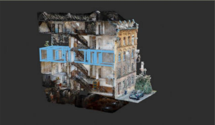
**05** Punktwolkenmodell eines Stockwerkes. Hier wurde ein Raum mit Hilfslinien digitalisiert damit er später in ein CAD Programm übertragen werden kann.
